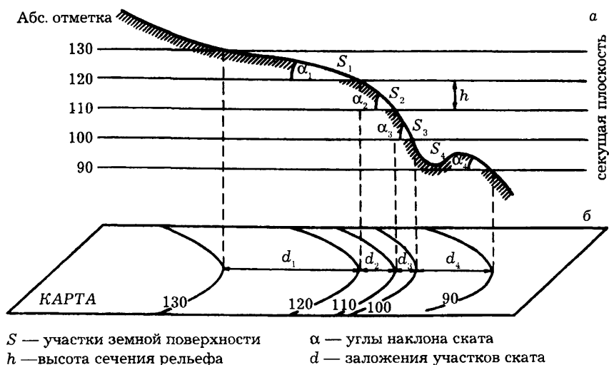
Рис. 5.9. Элементы ската (а). Отражение элементов ската с помощью горизонталей на карте (б)
