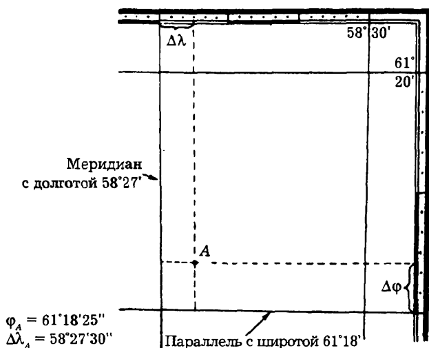
Рис. 8.26. Определение географических координат пункта A по топографической карте. Пунктирными линиями даны параллель и меридиан, проведенные через данную точку
